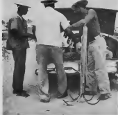
UN INSPECCION detorsida di e motor ta bon seguransa promer cu sali. Tur tapón lo mester worde cambia. Un articulo importante ta e anker, basta robey, y hopi cabuya. Si e motor mester faya, e anker ta preveni e boto di drief cu coriente y esaki ta facilita salvamento.
